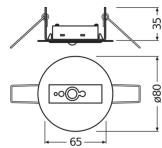
**Caractéristiques Osram DALI Sensor pour Ceiling installation 6m 40-90D LS/PD CI G2 BT1**
