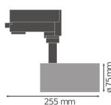
**Caractéristiques Ledvance Spot LED sur rail D75 Gris 25W 1750lm 24D - 930**
