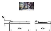
Technische Daten Philips LED-Highbay GentleSpace BY481P SMT-HDXT 162W 25000lm 44D - 840 | IP65 - Dali Dimmbar
