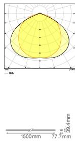
**Technische Daten Ledvance LED Tragschiene Trusys Flex Klar Stahl Weiß 70W 12100lm 120D - 840 Kaltweiß | 3 Stunden Notbeleuchtung**
