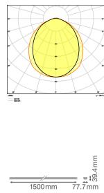
**Technische Daten Ledvance LED Tragschiene Trusys Flex Opal Stahl Weiß 50W 8300lm 90D - 840 Kaltweiß | 3 Stunden Notbeleuchtung**
