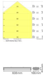
**Technische Daten Ledvance LED Feuchtraumleuchte 18W 2250lm - 830 | 60cm - 3 Stunden Notbeleuchtung**
