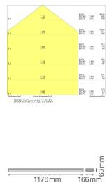
**Technische Daten Ledvance LED Feuchtraumleuchte 32W 4384lm - 840 | 120cm - 3 Stunden Notbeleuchtung**
