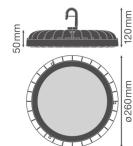
**Technische Daten Ledvance LED Highbay Compact Value 166W 20000lm 110D - 840 | IP65**
