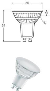
**Technische Daten Osram LED Superstar Reflektor Spot GU10 PAR16 6W 575lm 120D - 940 | Höchste Farbwiedergabe - Dimmbar - Ersatz Für 80W**
