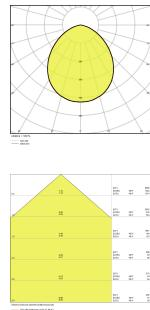
**Technische Daten Ledvance LED-Scheinwerfer Sensor GEN 3 Schwarz 50W 5500lm 100D - 830 | IP65 - Bewegungs- und Lichtsensor - Symmetrisch - Ersatz für 100W**
